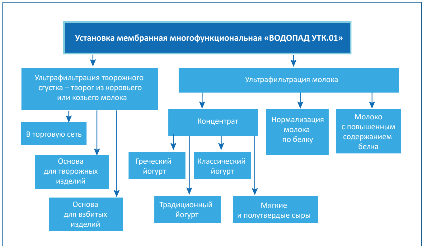
Рис. 2. Многофункциональная установка обеспечивает поочередное производство широкого ряда продуктов
